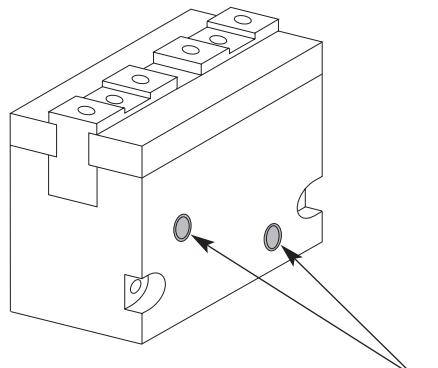
Connessioni pneumatiche filettate standard • Standard threaded pneumatic connections • Standard gewindegeschlitzte pneumatische Anschlüsse • Connexions pneumatiques filetées standard
