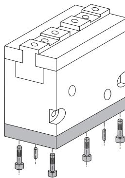
**Montaggio assiale - Fissaggio da sotto**
